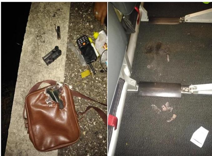
Daños en equipaje de cabina y elementos de aeronave por explosión de batería de un cigarrillo
